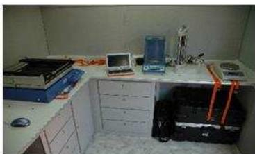
L'automezzo è attrezzato con strumentazione completamente automatica per il monitoraggio rapido dei parametri analitici nelle acque sia di falda che di scarico, con una cadenza analitica di 150 determinazioni l'ora.
